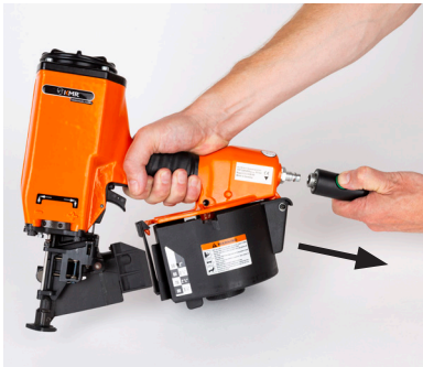
Gerät von der Luftversorgung trennen
