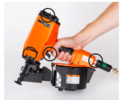
Prüfung auf Luftverlust und Undichtigkeiten
