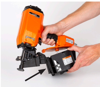
Überprüfung aller Schutz- und Magazinabdeckungen
